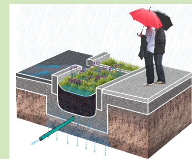
Biovaleta da ROW (faixa de servidão)
